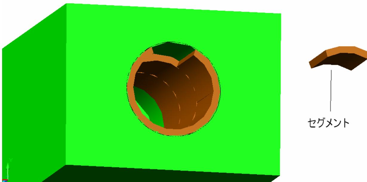
図—5. 4 掘削空洞内でのトンネル表現
