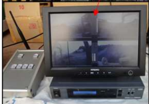
カメラ動画像伝送装置& 4画面モニター
