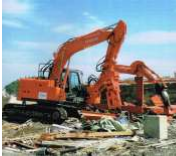
双腕バックホー(日立建機)
