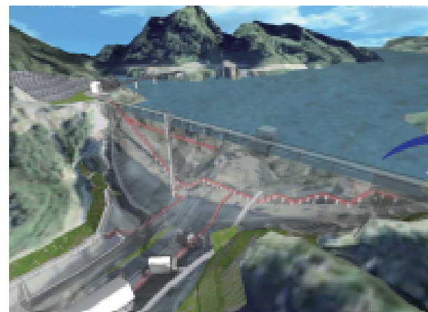
堤体：3次元的に堤体に配置された計器や 調査線、ケーブル等を見る化し、計測値 や点検結果と連動し、安全管理へ。
