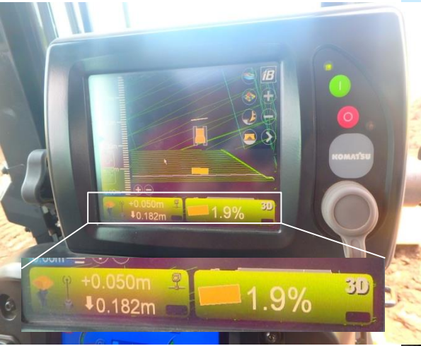
【ICT建機のブルドーザの液晶画面】 画面左下に「↓0.182m」は仕上がり面に対して0.182m下げる。 MC(マシンコントロール)の場合は、オペレータは前後進のみの操作で、ブレードは自動で上下する。
