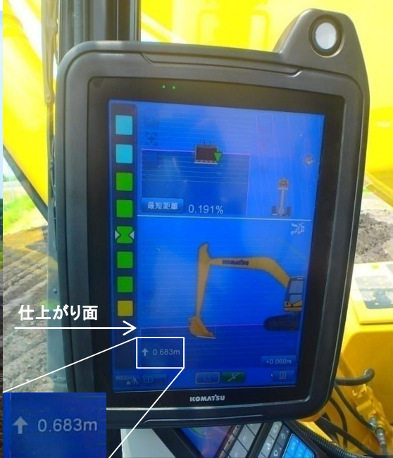
【ICT建機のバックホウの液晶画面】 画面左下に「↑0.683m」は仕上がり面に対して0.683m上げる(盛土作業のため仕上がり面が原位置より上になっている)。
