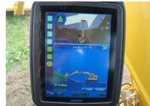
モニターによる施工状況の確認(6月8日撮影)
