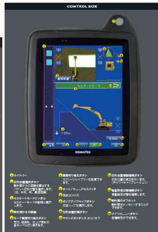
PC200-iモニタ (ICTバックホウのモニタ画面の例)
