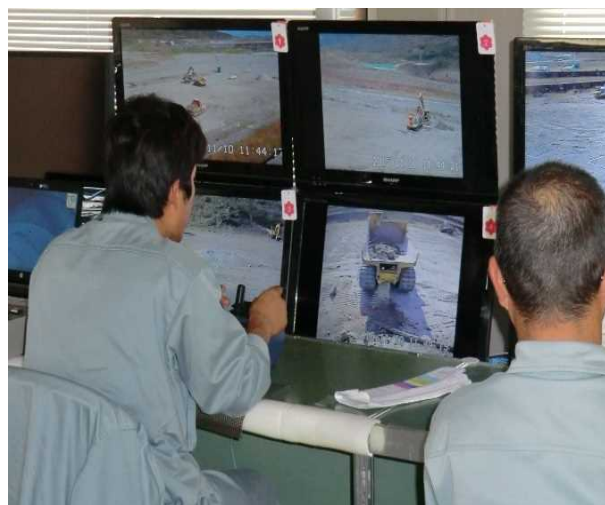
映像掘削実施状況
