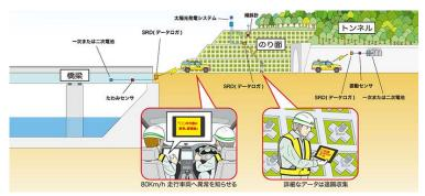
橋梁、法面、トンネルに設置した各種センサなどで取得したデータを、ucode(モノや場所などを識別するための固有ID)が格納されたSRDデータロガーと呼ばれる短距離無線通信装置(周波数920MHz)で収集・蓄積し、異常値を計測した場合に、高速走行中(時速80km)の点検車両(巡回車)に乗車している点検者の持つ端末に知らせる。
